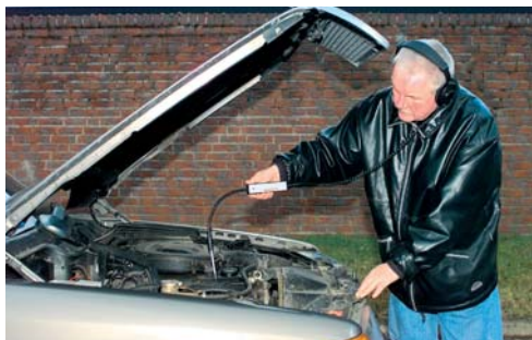
Diagnose defekter Zusatzaggregate mit dem Stethoskop
